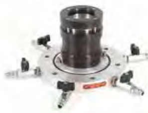
Adaptador CRS (26-WF0360/AD) equipado en la base inferior de la célula triaxial acanalada.
