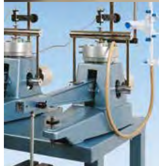
Tres edómetros 26-WF0302, con células, transductores electrónicos de desplazamiento 30-WF6207 conectados a 30-WF6008 GEODATALOG, y banco de consolidación 26-WF0312.
