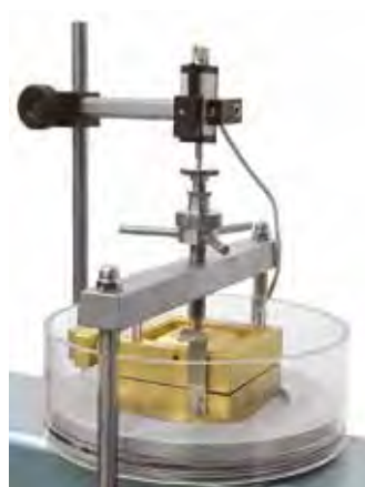
Detalle de la carcasa de la caja de corte montada en modo electrónico
