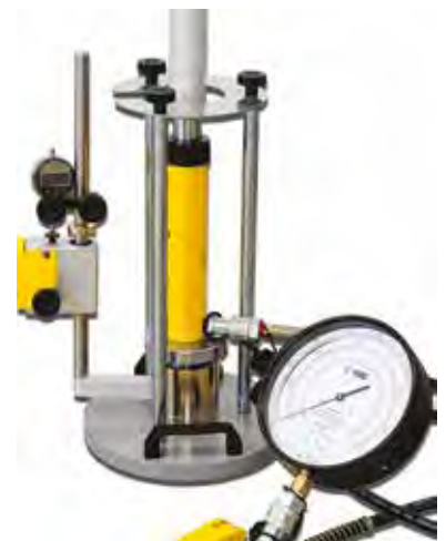
Detalle del conjunto hidráulico del 35-T11D1: manómetro de escala triple e indicador digital 82-D1262/B
