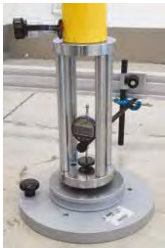
Túnel de medición 35-T1100/MT adecuado para la configuración de dispositivos de desplazamiento simple
