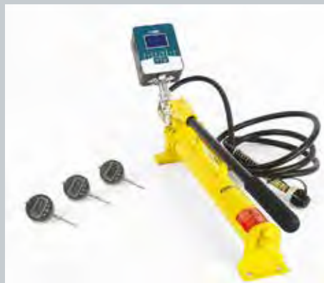
Versión digital con indicadores digitales de 25,4 x 0,001 mm y unidad de lectura de carga digital (funcionamiento con batería) con transductor de presión integrado
