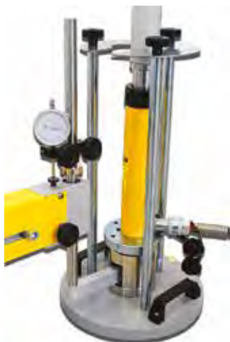
Detalle del conjunto hidráulico del 35-T11D1: placa de carga de 300 mm de diámetro, cilindro hidráulico con asiento esférico y varillas de extensión, brazo telescópico, túnel de medición, dispositivo antivuelco de 3 columnas y reloj comparador
