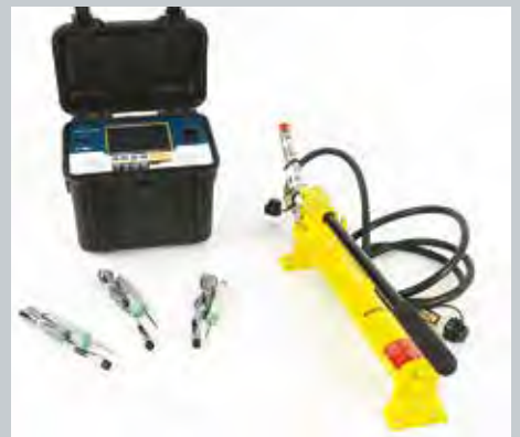
Versión electrónica con transductores de presión y desplazamiento de 50 mm de recorrido, conectados al Datalog 8, funcionamiento con batería, incluye maleta rígida adecuada para su uso in situ . Ver página 416.
