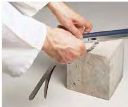
Verificación de la planicidad usando el reglón 82-C0108/1 y juego de galgas de grosores 82-C0110/1
