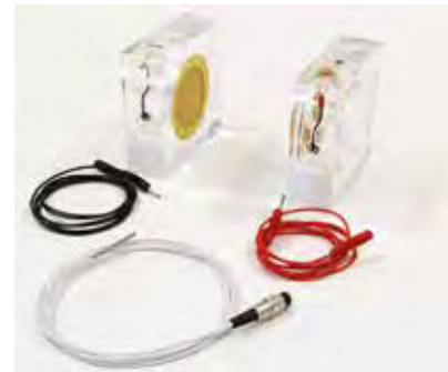
Célula de ensayo para el medidor de penetración del ion cloruro
