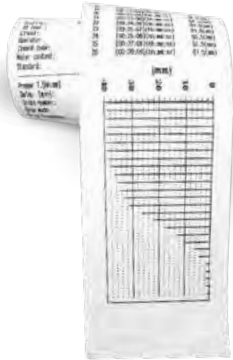
Un gráfico típico del resultado de un ensayo obtenido con el modelo de impresora integrado 65-L2700/PR que incluye diagrama y lecturas del tiempo de fraguado en formato gráfico y numérico
