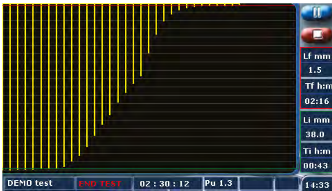
Gráfico del tiempo de fraguado mostrado en tiempo real en una pantalla VICAMATIC-2
