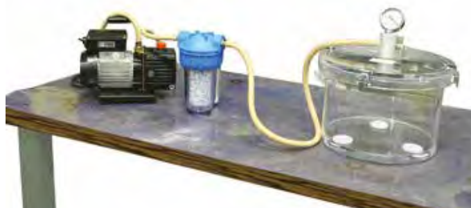
75-D1122 con sistema de vacío de desaireación, incluye bomba de vacío 86-D2003, unidad de secado de aire 86-D2005 llena de desecante de gel de silicio 86-D0819 y dos tubos de goma 86-D2064.
