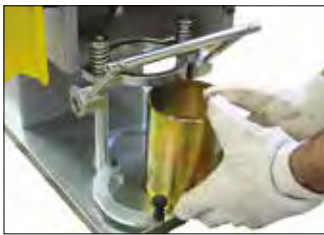
Compactadores EN y ASTM. Detalle del mecanismo de fijación
