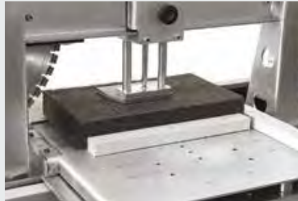
Dispositivo de sujeción para planchas incluido en Autosaw II y Multisaw
