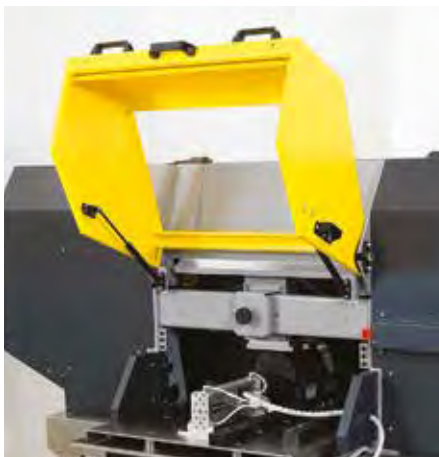
El armario de protección garantiza un fácil acceso para la colocación de la muestra, un funcionamiento seguro y protección contra el rociado durante el proceso de corte. Varias puertas con cierre automático en la parte delantera, trasera y superior evitan que el operador acceda a áreas peligrosas mientras disco de corte está en funcionamiento
