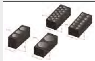
- Utilizando el sacatestigos se pueden extraer muchas muestras cilíndricas de una viga prismática
