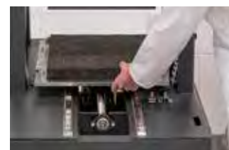
Sistema con plancha de 500 x 400 mm y husillo a bolas de precisión
