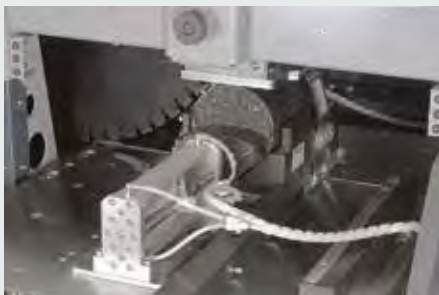
Dispositivo de acoplamiento automático para testigos de 100/150 mm de diámetro. Compatible únicamente con Autosaw II
