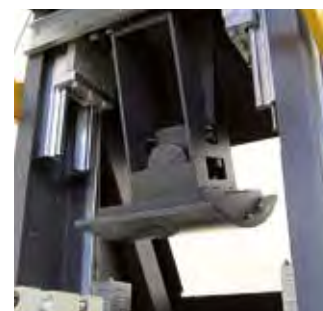
Detalle del cabezal que incorpora la unidad de vibración
