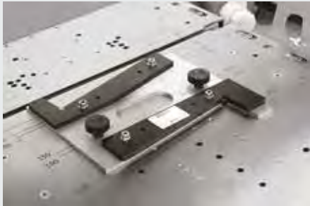
Dispositivo para muestras trapezoidales para flexión en dos puntos
