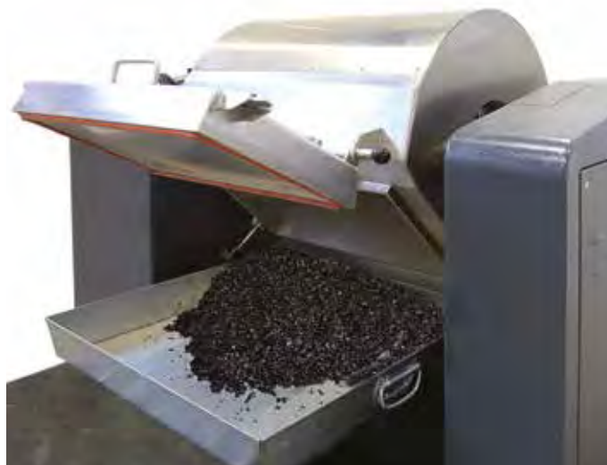
Detalle de la descarga: el cilindro de mezclado gira mediante un sistema de inclinación motorizado para facilitar la descarga. El ángulo de inclinación se ajusta a 130° para acelerar el proceso de descarga.
