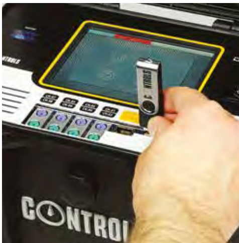
Unidad de adquisición de datos DATALOG 8 modelo 82-P9008/F. Detalle de la memoria USB extraíble
