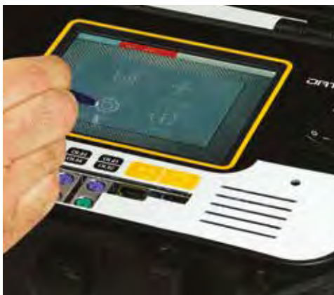
Unidad de adquisición de datos DATALOG 8 modelo 82-P9008/F. Detalle de la pantalla táctil gráfica a color de 6"
