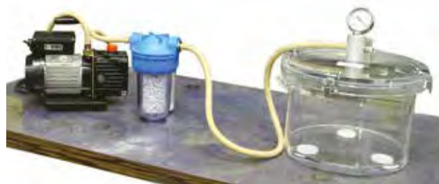
Aplicación típica de 86-D2005 durante la determinación de la densidad máxima de mezclas bituminosas usando el picnómetro de tamaño grande 75-D1122
