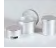
Contenedores de humedad, 86-D1330 a 86-D1332
